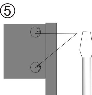
PEVNĚ DOTÁHNĚTE ŠROUBY POMOCÍ PLOCHÉHO ŠROUBOVÁKU. V HORNÍ ČÁSTI POSTELÉ TO SAMÉ PROVEDETE SE ŠROUBY
